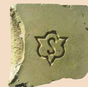
Obr. 95 Část slinuté cihly Bild 95 Teil eines gesinterten Ziegels
